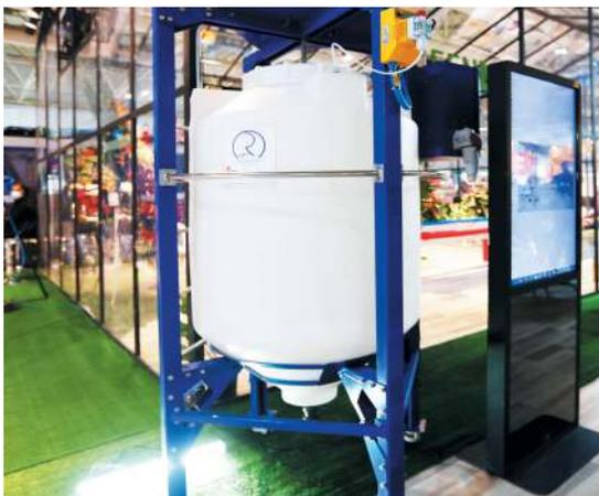
традиционное использование удобрений. Система дозирования удобрений Greenman оснащена точной панелью управления и различными датчиками и добавляет питательные вещества, необходимые растениям, в воду, существующую в резервуарах из ПВХ
